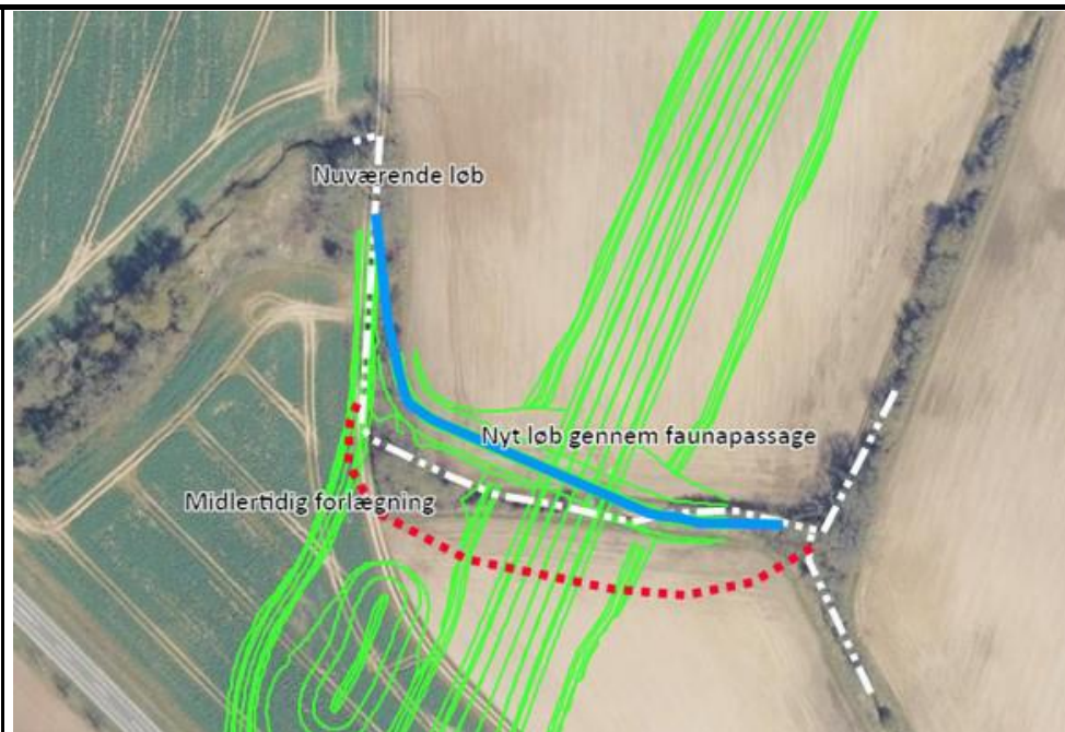
Midlertidig (stiplet rød) og permanent (blå) forlægning i St. 0+577
